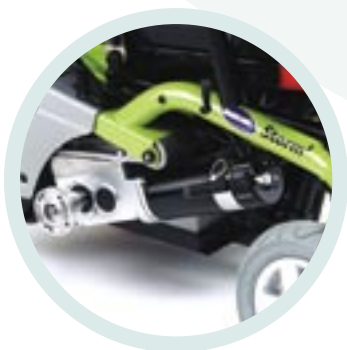
Extra starke Motoren für 30% mehr Leistung
