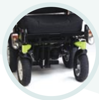
Einarmige Lenkradgabeln im modernen Design begrenzen Schäden im Falle eines Zusammenstoßes
