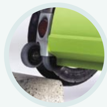
Doppelte Anti-Kipp-Räder für Hinterradstabilität und zum Überfahren von Bordsteinkanten
