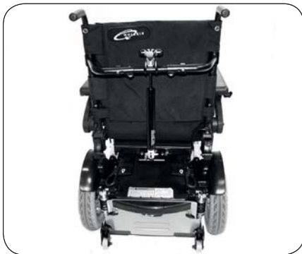
Manuelle Rückenwinkelverstellung 0° bis -30°: Gasdruckfeder Zwei Breiten: 41-46 cm oder 48-51 cm
