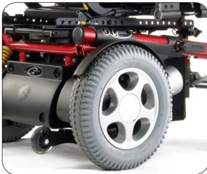
Heckantrieb mit Schwerpunkt über dem Antriebsrad; für perfekte Geschwindigkeitskontrolle in den Aussenbereichen.
