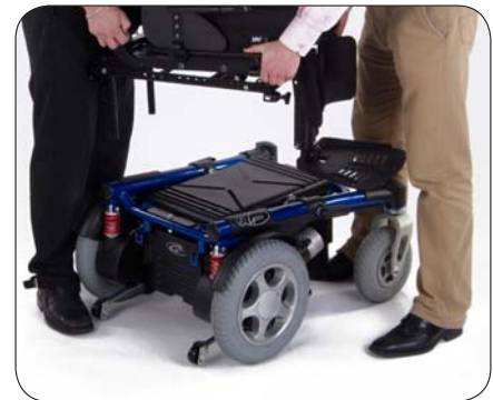
Umbau von Front- auf Heckantrieb und umgekehrt, in kürzester Zeit.
