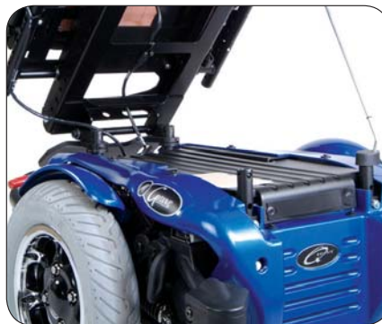
Die Groove Serie wurde so konzipiert, dass alle antriebsrelevanten Komponenten leicht und schnell zugänglich sind.
