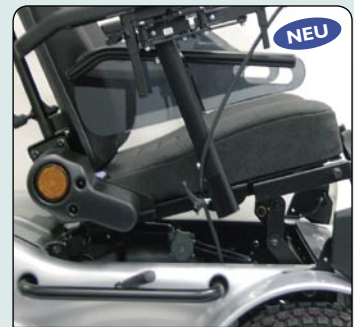
Sitzwinkelverstellung In Stufen fest (Standard) oder stufenlos elektrisch (Option) einstellbar.
